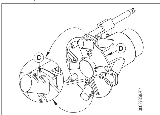
3) Расположить отверстия (С) на уровне диска пламени (D), как показано на рисунке; хорошо зафиксировать редукторы, затянув соответствующие винты.
